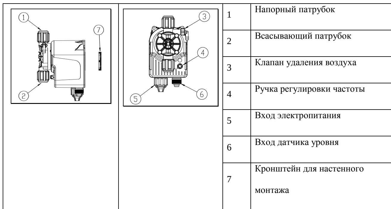
Рис. 10. Составные части насоса
