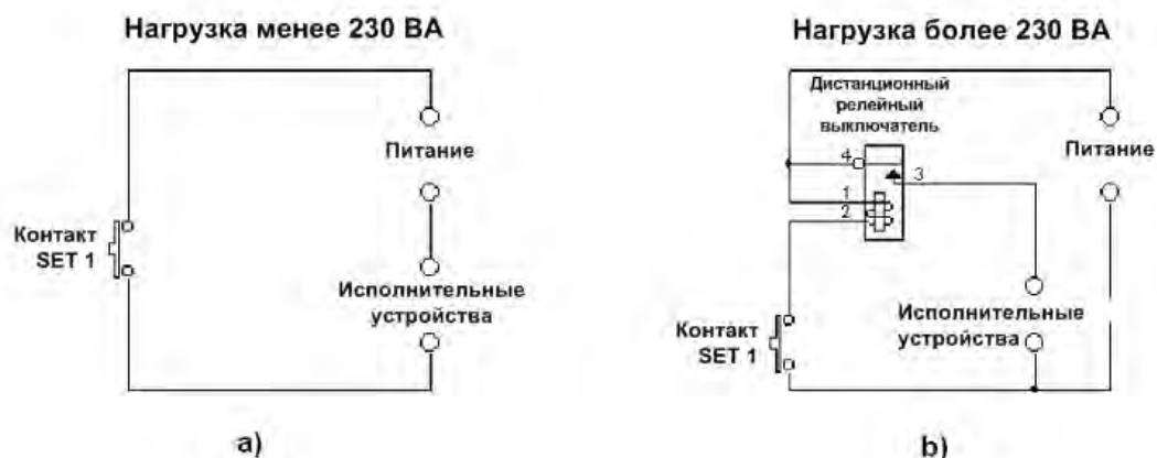
Рис. 6 Примеры соединения с исполнительными устройствами
